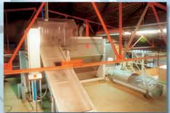
Pneumatic Conveying with Blow-Through-Valve Pneumatische Druckförderung mit Durchblassschleuse Transport pneumatique avec vanne alvéolaire Trasporto pneumatico con rotovalvola
